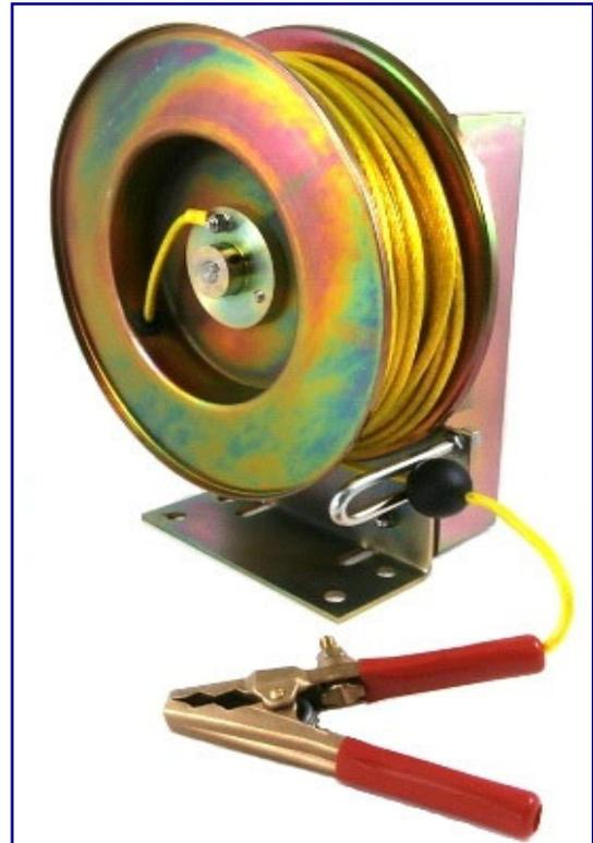
Das Herz dieser Kabeltrommel ist die Edelstahl Sprungfeder. Sie hält ca. 20.000 Zyklen und befindet sich in einem komplett abgedichteten Gehäuse, so dass weder Wasser noch Schmutz die Funktion beeinträchtigen können.
