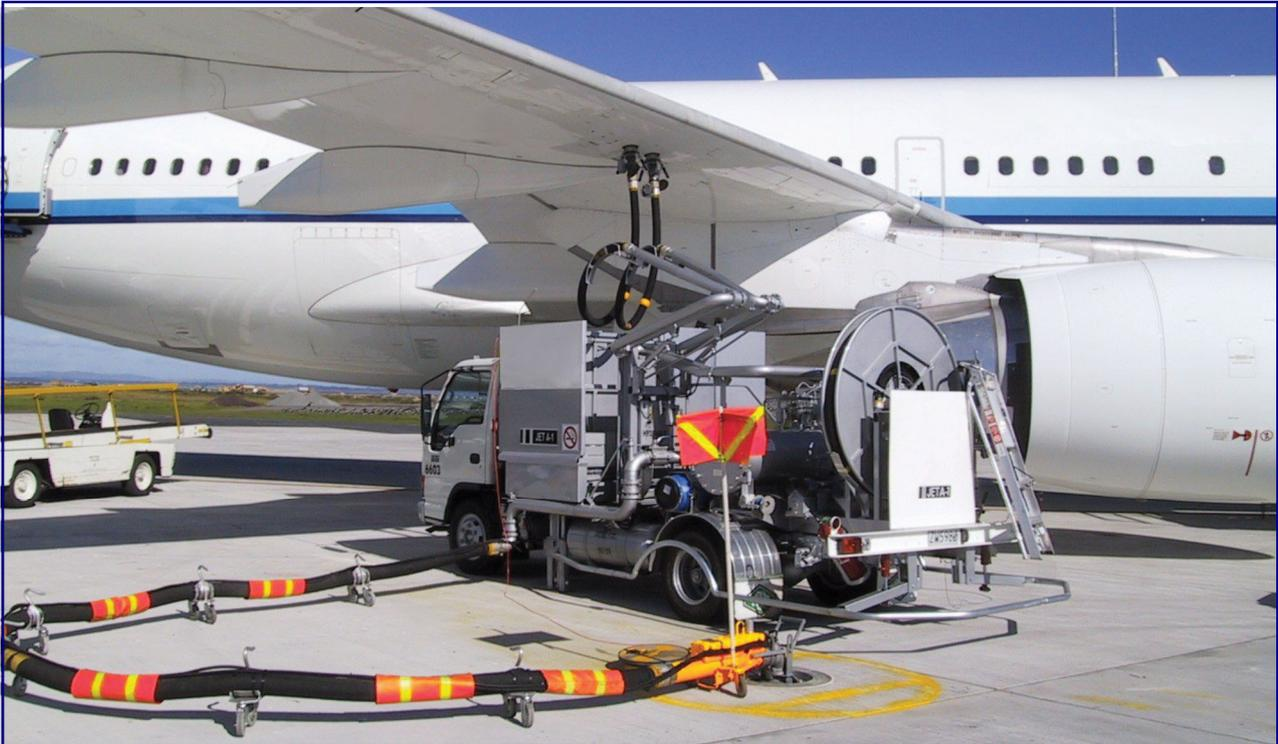
Das neue "Krokodil" ist eine Vorrichtung zur Positionierung der Eingangskupplungen am Hydrantenpit ohne den üblichen Kraftaufwand. Das Biegen und Heben von Eingangskupplungen kann eine gefährliche Sache sein, denn möglicherweise haben die einwirkenden Kräfte beim Tankwart eine Zerrung der Rückenmuskulatur zur Folge.
