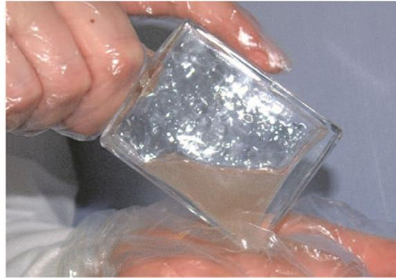
6. Klopfen Sie gegen die Flasche, bis eine flache Gelschicht entsteht. Legen Sie die Flasche flach (wobei sich die Gelschicht auf dem Boden befindet) an einem warmen, dunklen Ort ab und lassen Sie die Probe vier Tage lang bei 25°C (± 3°C) inkubieren. Untersuchen Sie die Probe mindestens einmal in den ersten drei Tagen und anschließend nach vier Tagen. Versuchen Sie, das Gel bei der Prüfung nicht zu stören.
