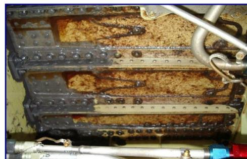
Mikrobenwachstum in einem Flugzeugtank
