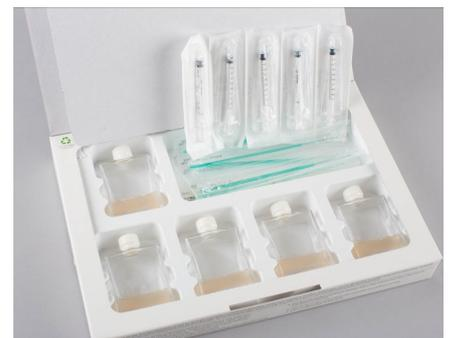
1. Schütteln Sie die Probe und lassen Sie sie stehen. Wenn freies Wasser vorhanden ist, bestimmen Sie, ob Sie den Kraftstoff/das Öl oder das Wasser prüfen möchten. Bestimmen Sie das empfohlene Testvolumen (Flugzeugtreibstoff 0,5 ml; andere Kraftstoffe 0,25 ml; Öl 0,01 ml; mit Kraftstoff/Öl verbundenes Wasser 0,1 oder 0,01 ml; siehe Merkblatt und die entsprechenden technischen Merkblätter für weitere Informationen).
