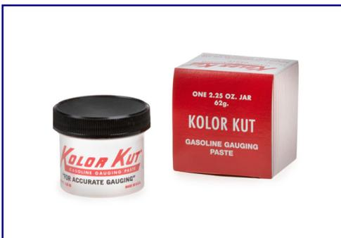
Kolor Kut Paste zum Aufspüren von Kraftstoff ist hell pinkfarben und färbt sich dunkelrot bei Kontakt mit den meisten Kohlenwasserstoffen. Der Füllstand kann deutlich am Messstab abgelesen werden, sogar wenn Verdunstung an der Oberfläche normalerweise das Ablesen verzerren würde.
