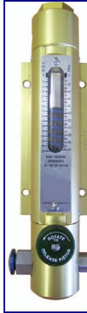
Messgerät mit Prüfventil und "Peak Hold"
